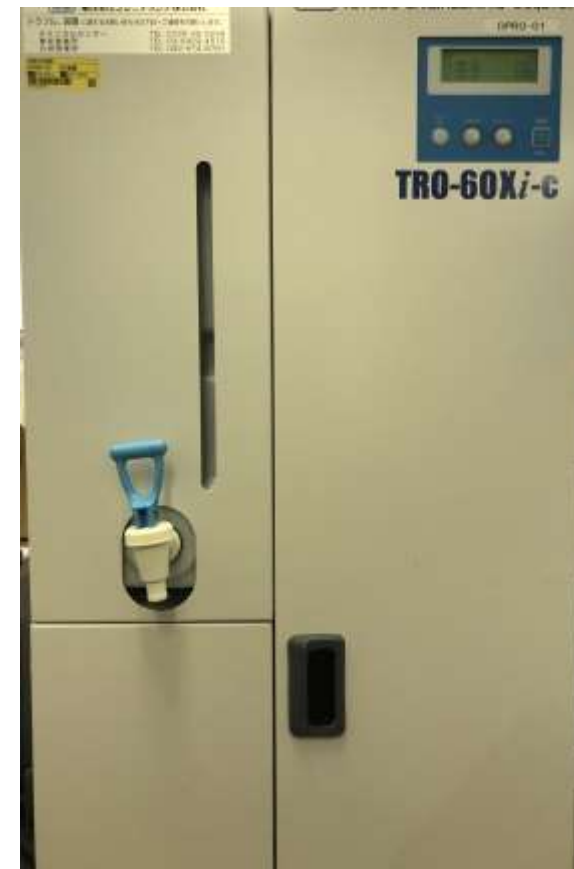
東洋紡RO純水製造 装置
